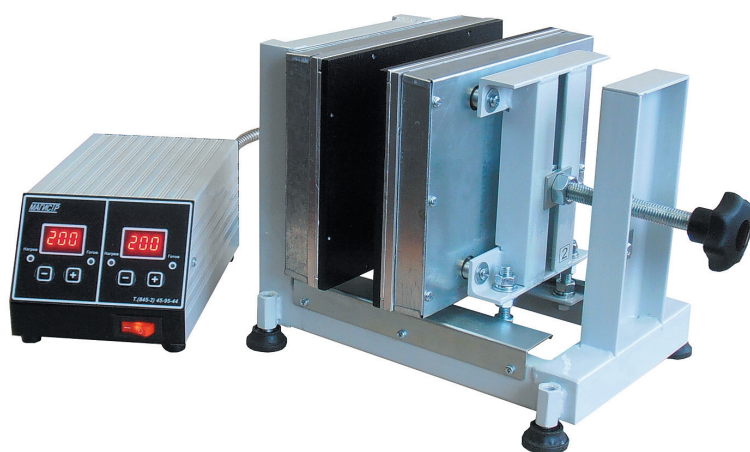
Рис. 10. Сдвоенный вертикальный термостол «Ц20-2Т»
