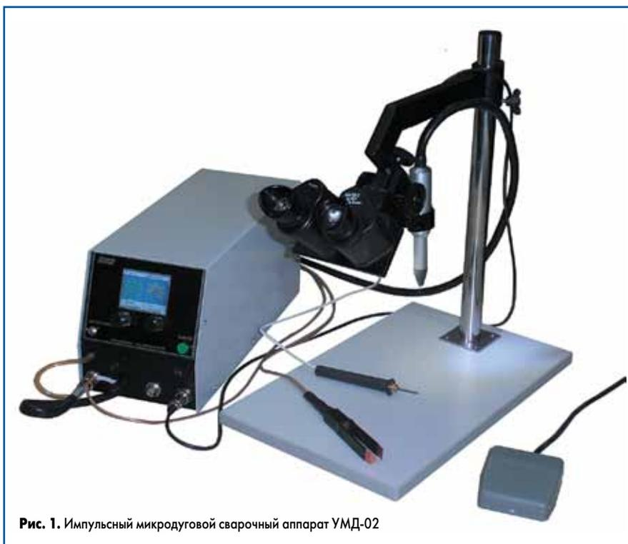
Рис. 1. Импульсный микродуговой сварочный аппарат УМД-02
