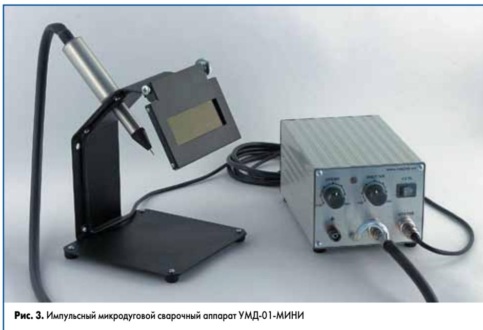
Рис. 3. Импульсный микродуговой сварочный аппарат УМД-01-МИНИ
