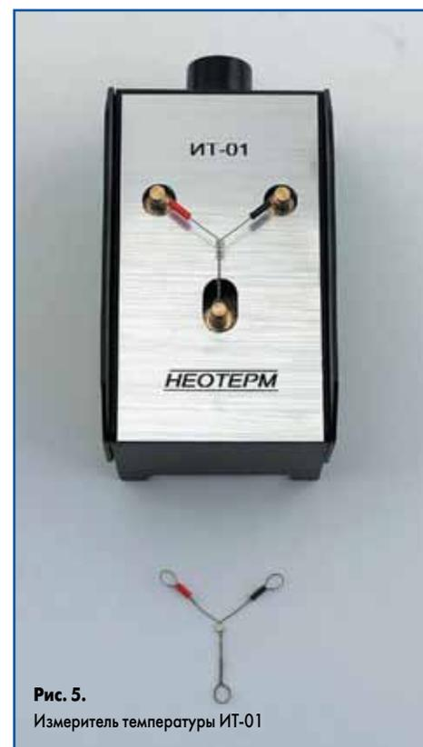
Рис. 5. Измеритель температуры ИТ-01
