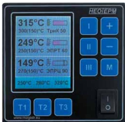
Рис. 2. Передняя панель паяльных станций
