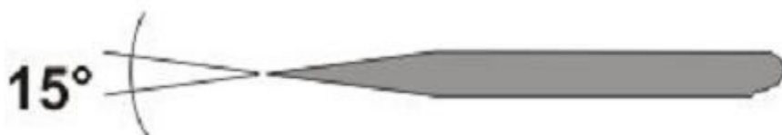
Рис. Форма заточки вольфрамового электрода
